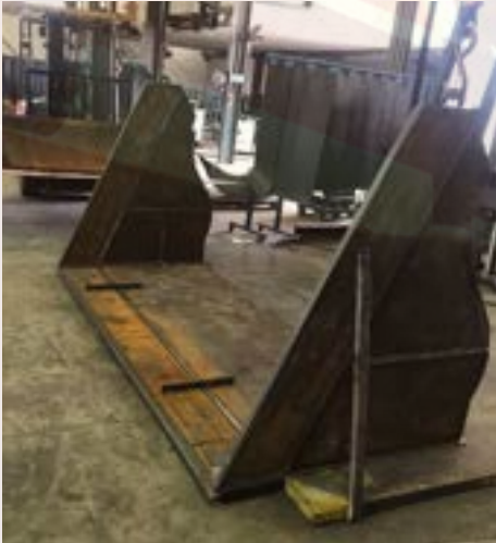
Anfertigung Rohkonstruktion: Seitenteile/Messer/Boden
