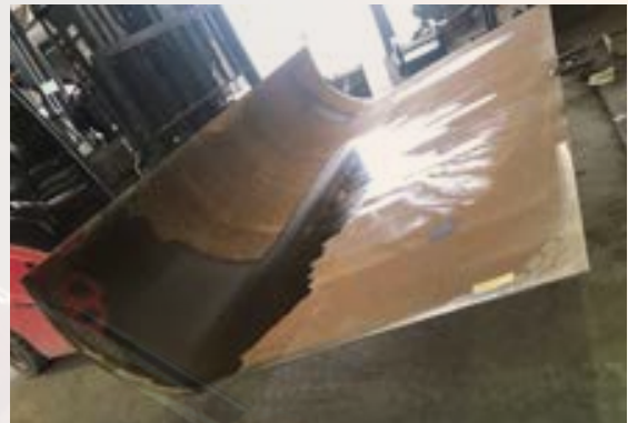
Biegen der Schaufelrückwand
