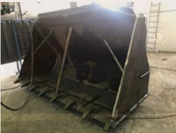
Fertige Rohkonstruktion: Zahnhalter eingeleftet
