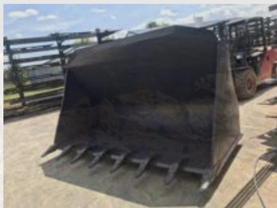
Fertige Schaufel: Schaufel für Radlader mit Schnellwechsler-Aufnahme passend für Volvo-System, Erdbauschaufel, Breite: 3080 mm Inhalt: 3 m 3 Wassermaß
