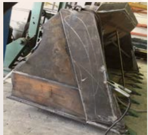
Fertige Rohkonstruktion beim Abschweissen
