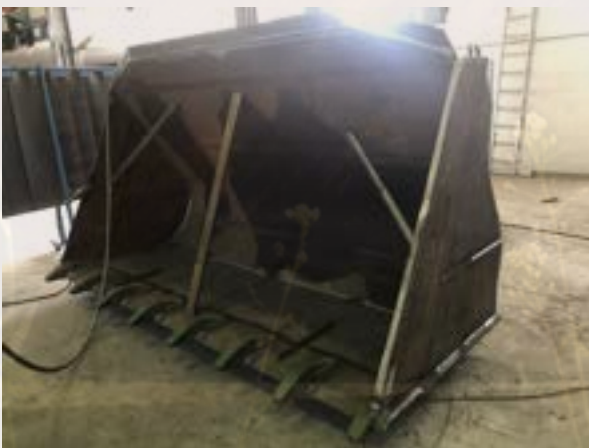
Fertige Rohkonstruktion: Zahnhalter eingeeftet
