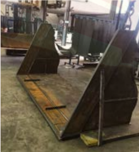
Anfertigung Rohkonstruktion: Seitenteile/Messer/Boden
