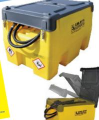
Tanks für Kraftstofftransport aus linearem Polyethylen, rundformgepresst, mit verschließbarem Deckel, Füllstopfen aus Aluminium, Sicherheitsventil, Umfüllungseinheit, integrierte Staplertaschen zum Anheben auch im vollbeladenen Zustand. Integrierte Tragegriffe für das Anheben im leeren Zustand. Sämtliche Einsätze sind aus eloxiertem Aluminium oder Messing hergestellt.
