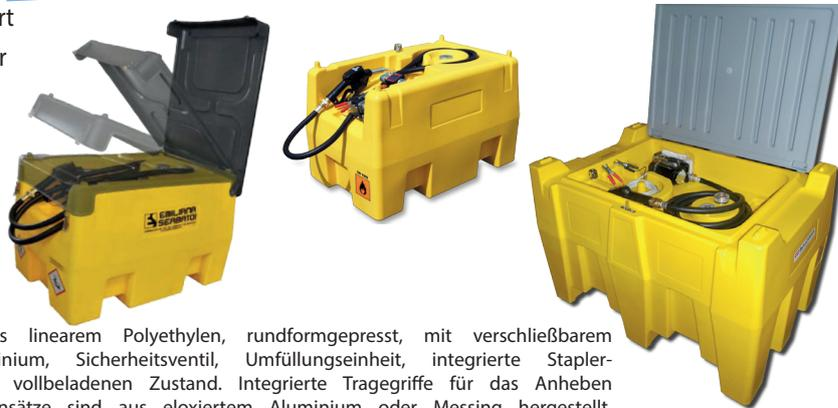
Tanks für Kraftstofftransport aus linearem Polyethylen, rundformgepresst, mit verschließbarem Deckel, Füllstopfen aus Aluminium, Sicherheitsventil, Umfüllungseinheit, integrierte Staplertaschen zum Anheben auch im vollbeladenen Zustand. Integrierte Tragegriffe für das Anheben im leeren Zustand. Sämtliche Einsätze sind aus eloxiertem Aluminium oder Messing hergestellt.
